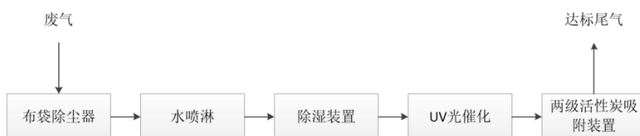
图 8.2-1 项目废气处理工程工艺流程图
